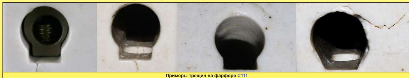
Примеры трещин на фарфоре C111
