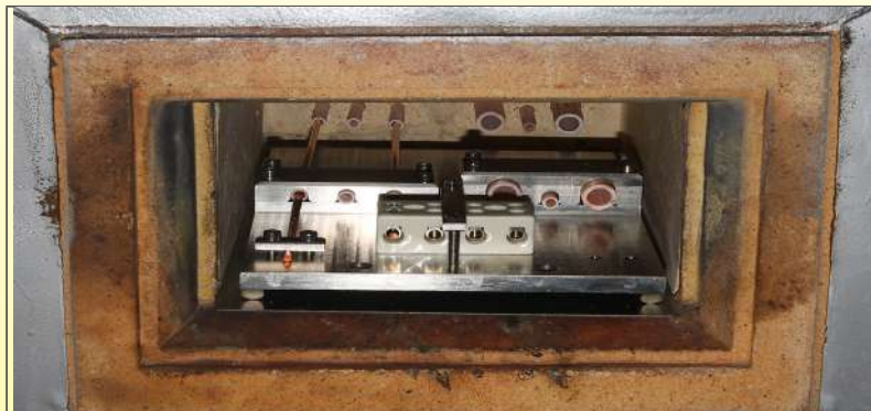
Испытательная печь для определения зависимости удельного сопротивления керамики от температуры (лаборатория Ultimheat)
